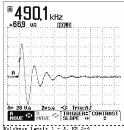
**Statorski namot trofaznog asinkronog motora 380 V; 1,1 kW; 1450 min<sup>-1</sup>**
